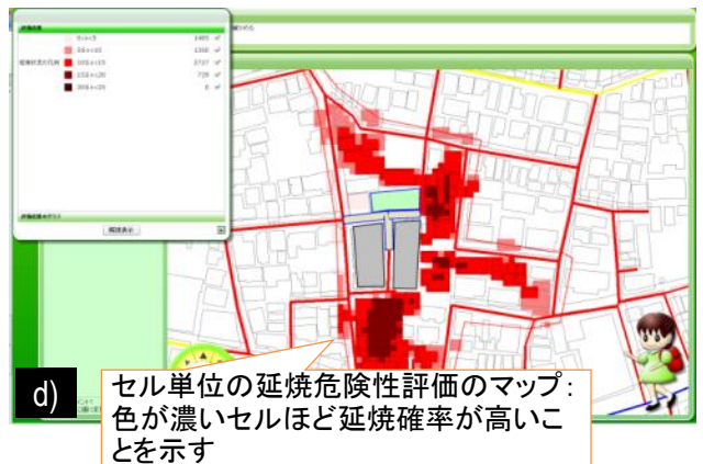
図 1-1 メインインターフェイスの表示例: a) 対象エリアの基本情報; b) 仮想整備検討スクリーン; c) 災害時行動困難性評価表示スクリーン; d) 延焼危険性評価表示スクリーン; e) 整備前後の評価結果の比較表示の例; f-1, f-2) 地域防災力評価結果の比較表示の例;
