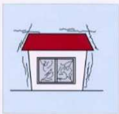
地震時、建物の揺れにより窓枠が変形し、ひずみによる飛散
