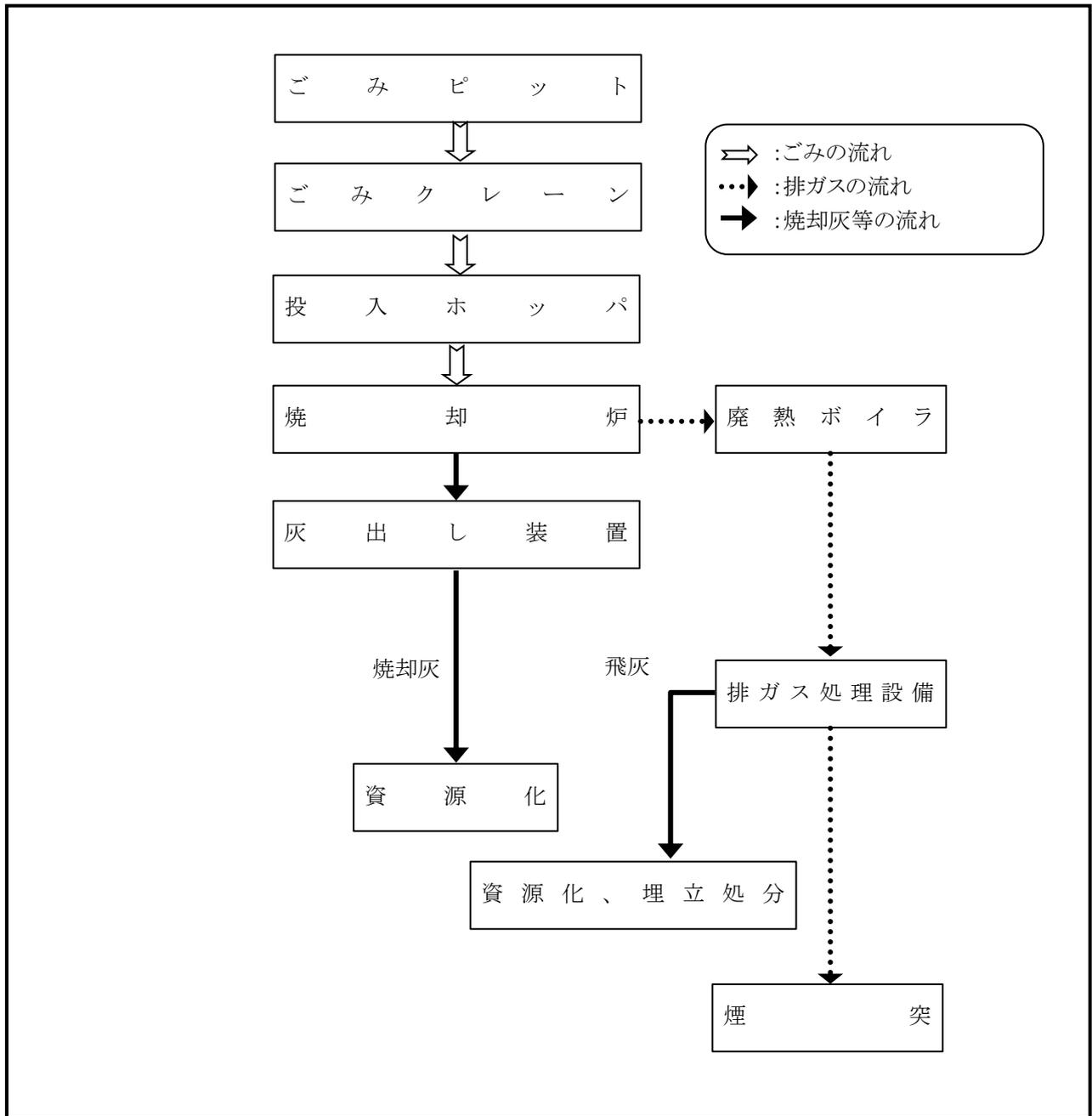
図2-2-7(1) 焼却方式+灰資源化の処理フロー
