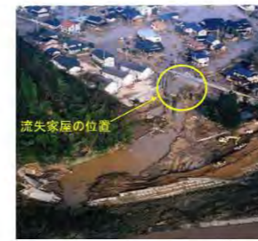
堤防決壊に伴う氾濫流により木造家屋が倒壊した状況
