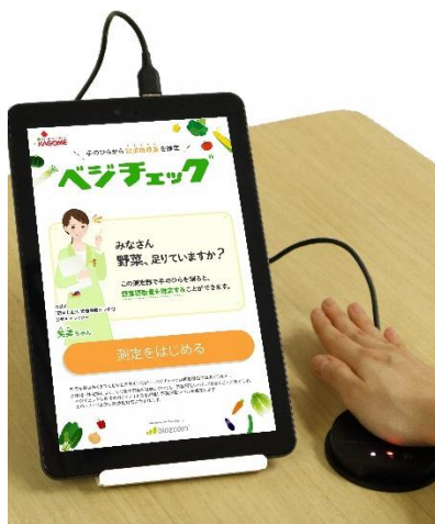
写真 2. センサーに手のひらをのせるだけで推定野菜摂取量が表示される『ベジチェック®』
