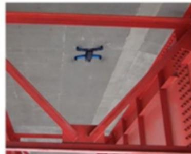
・ロボットカメラ 従来点検：橋梁点検車
