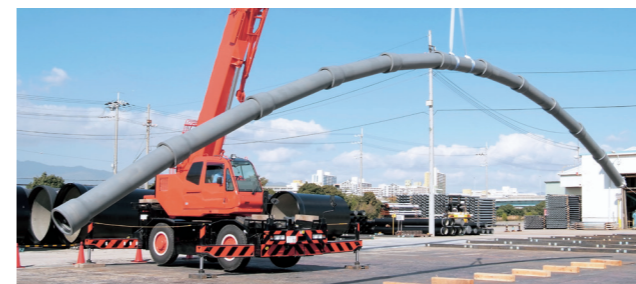
地震の際に抜けにくくなる管 (写真提供) 日本ダクタイル鉄管協会
