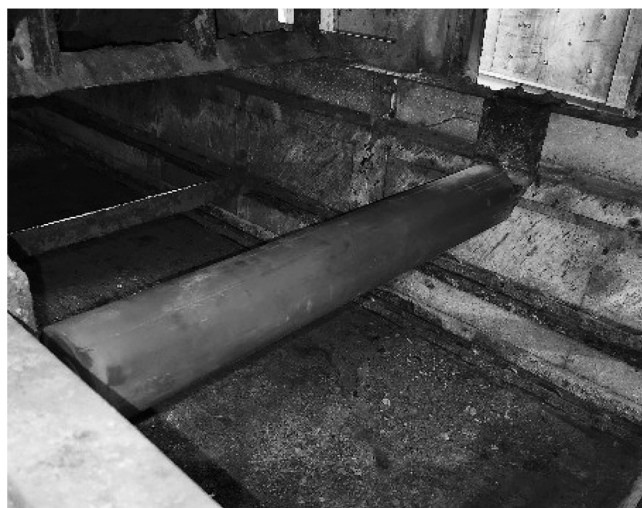
写真2 変更したリターンアイドラ
