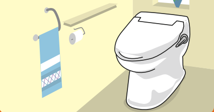
洗浄弁内蔵型大便器 (通称・タンクレス洗浄大便器)
