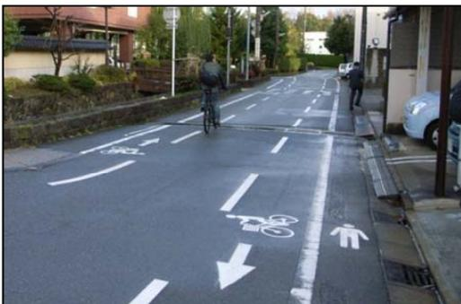
自転車と自動車が車道で混在。自転車の通行位置を明示し、自動車に注意喚起するため、必要に応じて路肩のカラー化、帯状の路面表示やピクトグラム等を設置
