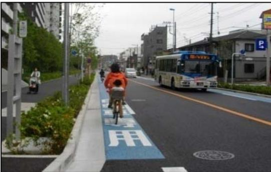
交通規制により指定された、自転車が専用で通行する車両通行帯。自転車と自動車を視覚的に分離
