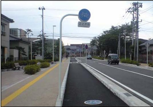
縁石線等の工作物により構造的に分離された自転車専用の通行空間
