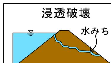
ため池の堤体に発生した亀裂などが、水みちとなって、徐々に大きくなり、決壊する場合があります。
