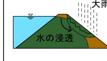
ため池に貯めている水や雨などが、堤体の中に浸透して、斜面のすべりが発生し、決壊する場合があります。また、地震により堤体がゆられるにより、斜面のすべりが発生し決壊する場合があります。
