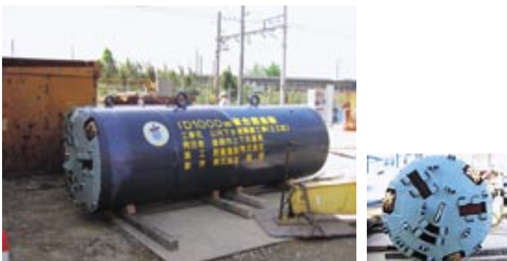
うめだだいいちおすいかんせん 梅田第1汚水幹線(大岩・二川地区) さいちようきろく たっせい きかい 世界最長記録を達成した機械 すいしんこうほう えんちよう きろく 推進工法というトンネル工事で延長1448mを記録
