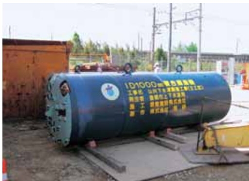
うめだだいちおすいかんせん 梅田第1汚水幹線(大岩・二川地区) さいちよきろく たっせい きかい 世界最長記録を達成した機械 すいしんこうほう えんちよ きろく 推進工法というトンネル工事で延長1448mを記録
