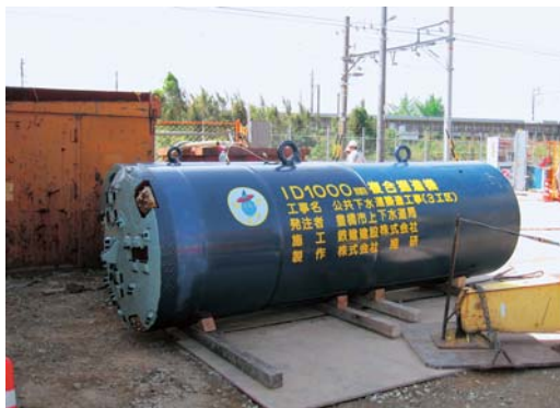
うめだだいいちおすいかんせん 梅田第1汚水幹線(大岩・二川地区) さいちようきろく たっせい きかい 世界最長記録を達成した機械 すいしんこうほう えんちよう きろく 推進工法というトンネル工事で延長1448mを記録
