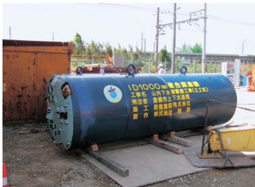
うめだだいいちおすいかんせん 梅田第1汚水幹線(大岩・二川地区) さいちようきろく たつせい きかい 世界最長記録を達成した機械 すいしんこうほう えんちよう きろく 推進工法というトンネル工事で延長1448mを記録
