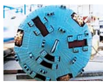
うめだだいいちおすいかんせん 梅田第1汚水幹線(大岩・二川地区) さいちようきろく たつせい きかい 世界最長記録を達成した機械 すいしんこうほう えんちよう きろく 推進工法というトンネル工事で延長1448mを記録
