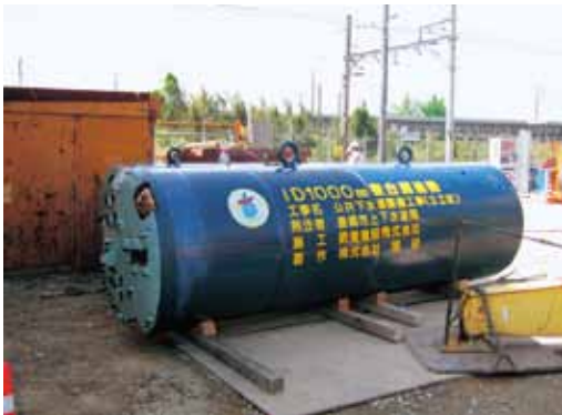
さいちようきろく たっせい きかい 世界最長記録を達成した機械 うめだだいいちおすいかんせん 梅田第1汚水幹線(大岩・二川地区)において すいしんこうぼう えんちよう きろく 推進工法というトンネル工事で延長1448mを記録
