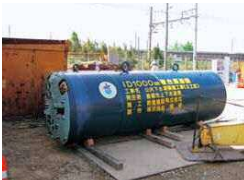
うめだだいいちおすいかんせん 2007年(平成19年) 梅田第1汚水幹線(大岩・二川地区) さいちようきろく たっせい きかい 世界最長記録を達成した機械 すいしんこうほう えんちよう きろく 推進工法というトンネル工事で延長1448mを記録
