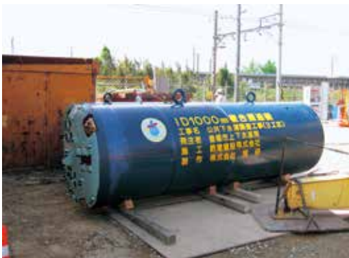
さいちようきろく たっせい きかい 世界最長記録を達成した機械 うめだだいいちおすいかんせん 梅田第1汚水幹線(大岩・二川地区)において すいしんこうほう えんちよう きろく 推進工法というトンネル工事で延長1448mを記録
