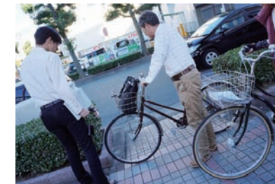
4) 自転車で段差や擦り付けの確認
