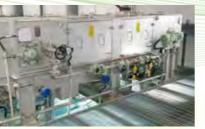
下水汚泥を発酵に適した濃度に濃縮します。
