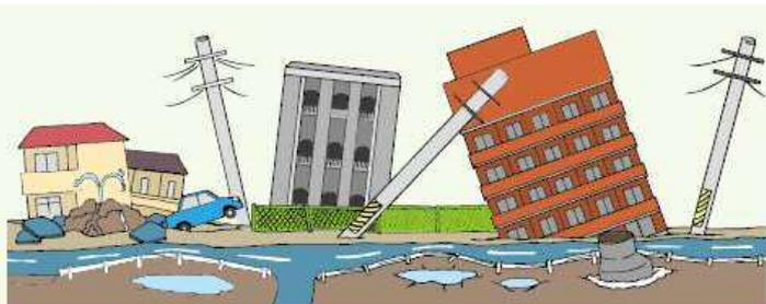
液状化は言葉のとおり、地盤が液体の様に流動的になってしまう現象のことです。砂が水と一緒に噴き出してくる**噴砂**や**噴水**が発生し、道路が沈下したり、段差ができるなどの被害が生じます。さらに、液状化した地盤は建物を支える力が小さくなってしまいますので、基礎がしっかりしていない家屋やビルなどの重い構造物は沈下したり傾斜したりしてしまいます。また、液状化した地盤は泥水のようなになるので、マンホールや下水管などのように中が空洞で軽い構造物は浮き上がってしまいます。
