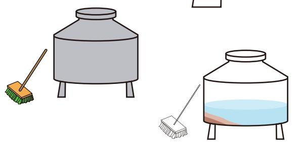
汚泥・赤さびなどの沈殿物が底にたまる
