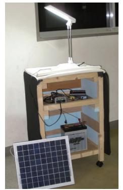
**内容** カーバッテリー(DC12V)にインバータを繋いで非常時の家庭用コンセント(AC100V)として使うことができます。また、ソーラーパネルに接続しているので、充電することができ、長時間電気を使用することができます。市販品や廃品を使うことで、安価に製作できます。
