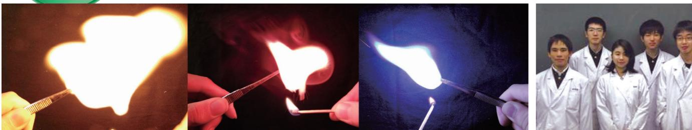
内容 濃硫酸と濃硝酸を混ぜて作った混酸に、セルロースを含む綿を浸し、セルロースを硝化させたニトロセルロース（硝化綿）を作りました。また、完成した硝化綿をほぐし、塩化銅(II)・塩化ストロンチウム・塩化バリウムの水溶液にそれぞれ15分間浸して、金属イオンを付着させ乾かしました。この作業により炎色反応を出しながら、一瞬で燃える綿を作りました。この硝化綿は、手品や科学実験講座などで小学生や中学生に紹介することにより化学について興味を持ってもらえると考えています。
